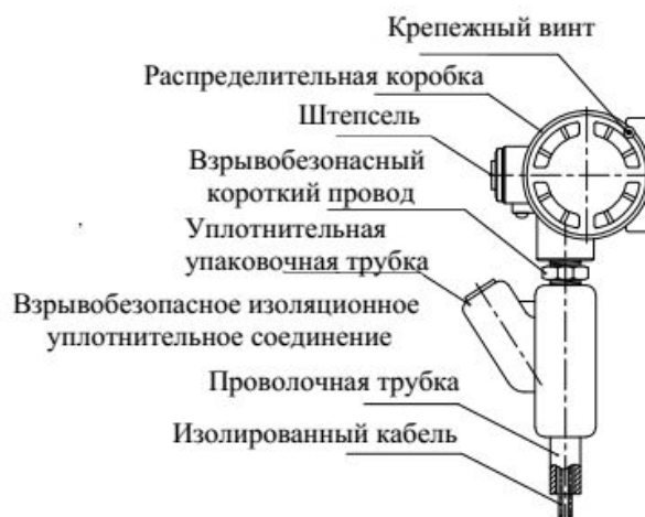
<Соединение герметичного взрывозащищенного проволочной трубки>
